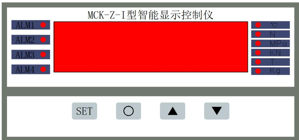
① ---测量值显示窗口; ②---报警指示区域; ③---单位指示区域; ④---按键区。
